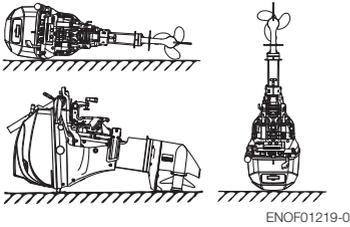
Al transportar el motor fueraborda manténgalo en una posición vertical. Se recomienda usar el soporte opcional del motor fueraborda para mantenerlo en posición vertical tanto durante el transporte como en el almacenamiento.
