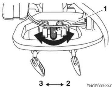
1. Palanca de fricción de la dirección
