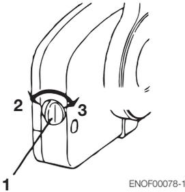
1. Tornillo de ajuste de la fricción del acelerador
