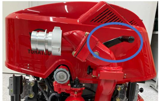
⑤ 再度エンジンを始動し、スロットルダイヤルを吸水の位置にして、真空ポンプを作動させてください。20秒後、吸水不能でエンジンが自動で停止します。
