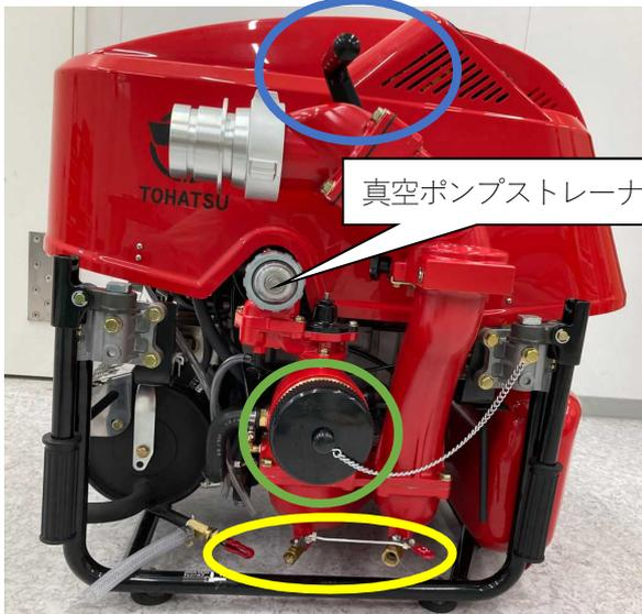
③ 自動吸水スイッチをONにしてください。エンジン始動後、スロットルダイヤルを吸水の位置にし、真空ポンプを約10秒間作動させてください。スロットルダイヤルを低圧の位置にし、エンジンを停止してください。
